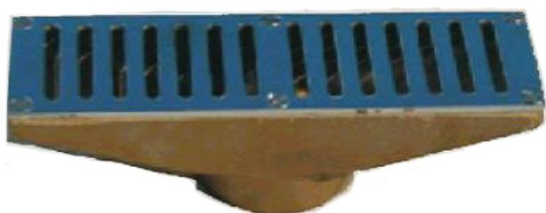
Por ser un rebosadero fabricado en base de bronce y rejilla de acero inoxidable, tiene mayor durabilidad sirviendo también como coladera en lugares donde se requiera una mejor vista. Esta cuenta con un conector roscado de 2" en la parte inferior donde puede instalarse el niple roscado modelo N2-8 facilitando su instalación.
