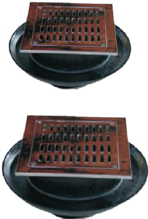
El cuerpo es de hierro gris y rejilla inoxidable, tiene un diseño cuadrado y cuenta con una tapa removible. La F-610-4 en su parte inferior, tiene un conector roscado a 4" y la F-710-6 el conector roscado es de 6". Además podemos ofrecer para su instalación los niples roscados N4-25 y N6-25 respectivamente y así facilitar el montaje. Sus aplicaciones pueden ser en interiores y exteriores, teniendo una vista agradable.
