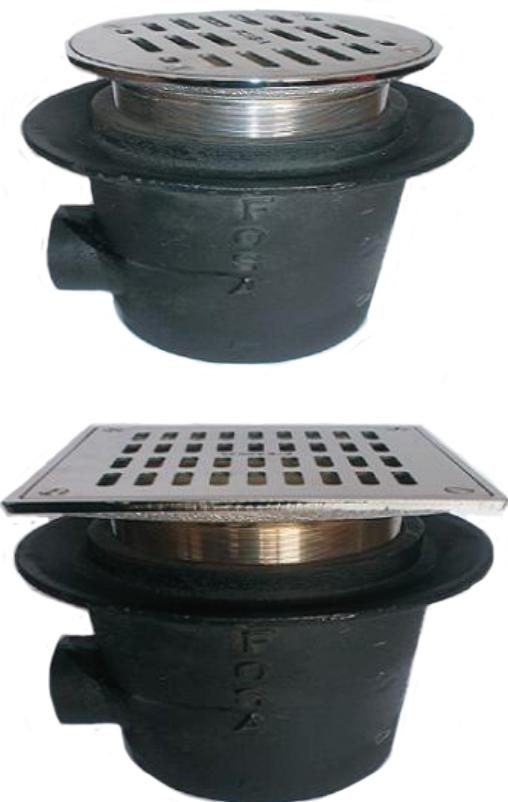
El uso y aplicación de este modelo es equivalente a los modelos 125 con la diferencia que en el modelo mostrado se cuenta con una mayor capacidad y tamaño en el sello hidráulico. La ofrecemos con una altura de 26.5 cms., un conector roscado de 2" con la opción de tapa redonda y cuadrada.
