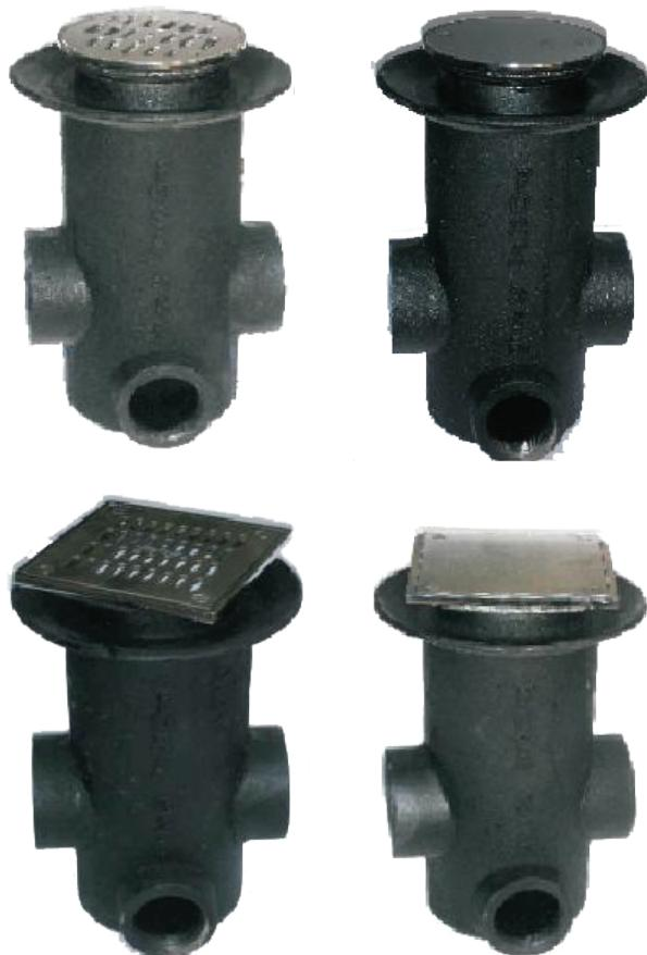
Estos modelos de coladeras tienen dos conectores rosados de 2" y un conector inferior rosado de 1 1/2", con su altura de 25 cms. Se puede aplicar en lozas de 10 cms. de grosor, quedando libres los conectores sin necesidad de fracturar el concreto y así facilitar su mantenimiento cuando existe el plafón falso.
