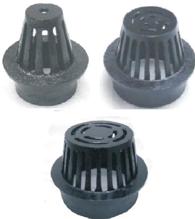
Fabricado en hierro vaciado. Las canastillas ensamblé están diseñadas para usarse en azoteas y lugares donde no existe tráfico como los canalones de las naves industriales y puede sustituir a la famosa "ardillera" que fabrican los intaladores en las obras con sobrantes de varilla corrugada.
