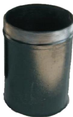
Consiste en un niple de hierro vaciado para conectarse a nuestras coladeras. En un extremo tiene una rosca exterior y espiga en el opuesto que puede conectarse a una abrazadera de acero inoxidable FOSA-TEP y así facilitar la continuación de la instalación sanitaria.
