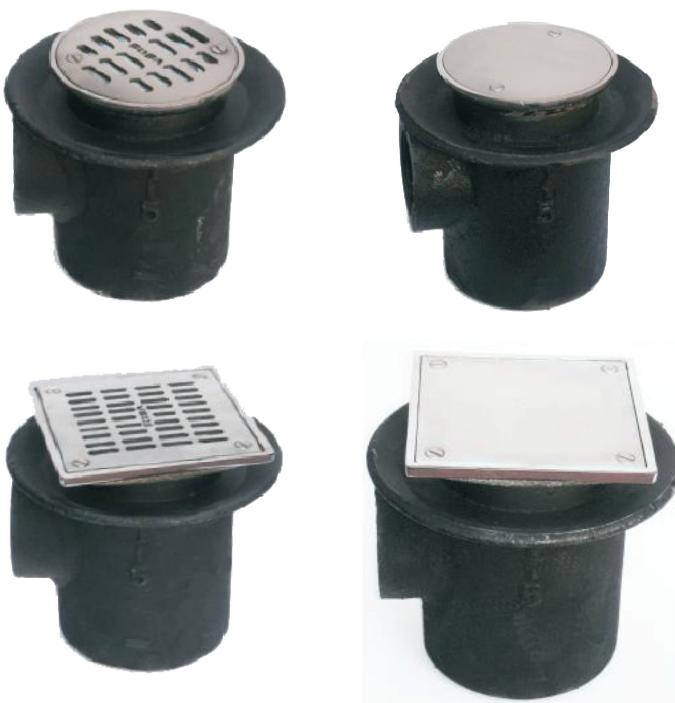
Este modelo es el más común de todos, el cuerpo es de hierro vaciado, las contras y diferentes tipos de rejilla son de acero inoxidable. La contra está roscada a 3" y además tiene una altura ajustable de 1" para los niveles a piso terminado. El cuerpo cuenta con un conector roscado de 2" y una altura de 15 cms. El casquillo para la trampa de olores es de PVC hidráulico de 2.5" para facilitar la limpieza.
