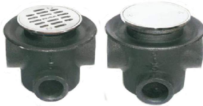
Cuenta con dos conectores roscados a 2" y un conector inferior de 1 1/2", para recibir el drenaje de una tina funcionando como sello hidráulico y los dos conectores superiores se pueden elegir tomando en cuenta la necesidad de la instalación. Al igual de poder escoger el tipo de rejilla que sea necesario.
