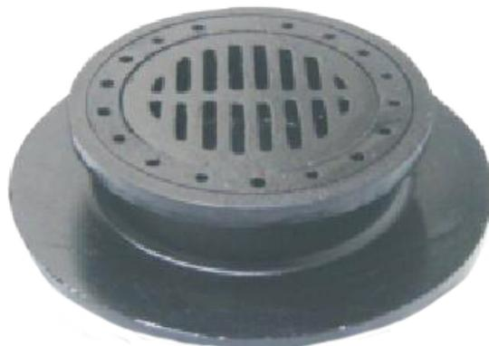
Estas coladeras son de hierro vaciado. Se componen de tres piezas: tapa, canasta y cuerpo, donde la canasta tiene perforaciones en el cuerpo y en la ceja obteniendo con esto un doble drenaje. Además cuenta con un conector roscado de 4" y 6" respectivamente.
