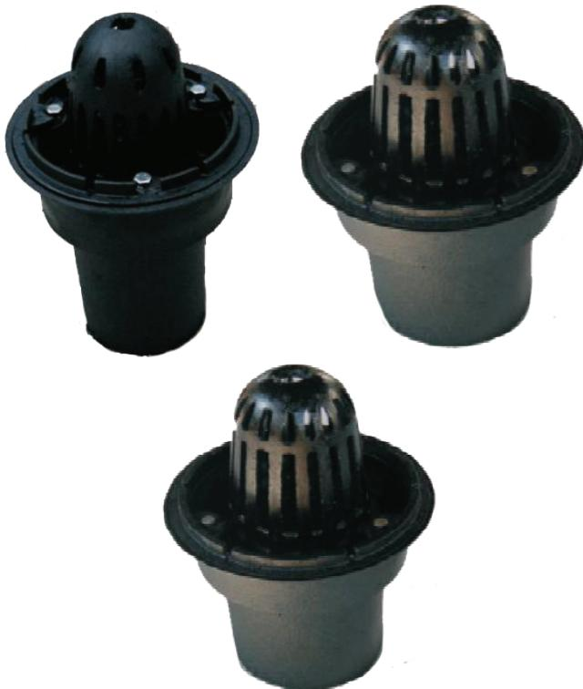
Fabricadas totalmente en hierro gris. Estos modelos se recomiendan para azoteas. Cuentan con una cúpula removible para poder dar mantenimiento. Se ofrecen con espigas de 4", 6" y 8". Pudiéndose escoger el tipo de instalación FOSA calafateado o con cople de acero inoxidable FOSA- TEP.
