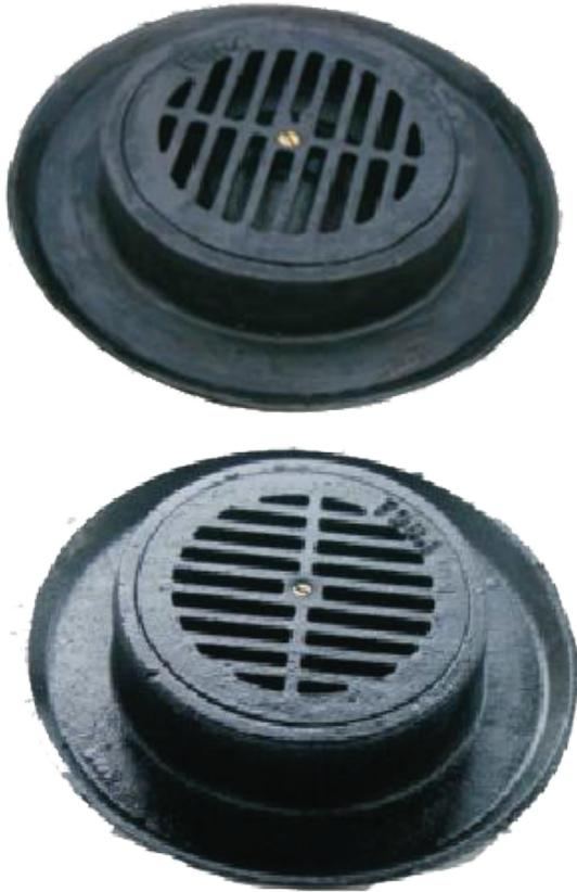
Estos modelos están fabricados totalmente en hierro gris, llevan un céspol integrado. Tiene un conector roscado de 4" y 6" respectivamente donde se pueden instalar los niples roscados N4-25 y N6-25. Su aplicación puede ser en pisos de terrazas, plantas industriales, cocheras y algunos otros lugares donde exista tránsito pesado.
