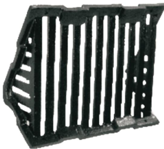
Consta de una rejilla con doble drenaje tanto en la parte superior como en la inferior evitando con esto el acumuloamiento de sólidos. Se puede instalar en los pretilles de las construcciones ya edificadas que tengan instalada una ardillera fijándola fácilmente con cuatro clavos.
