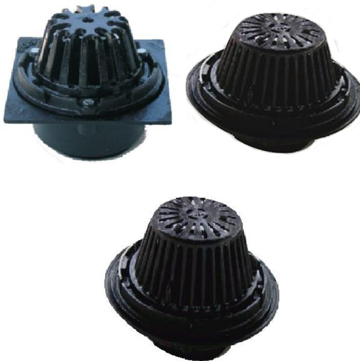
Estas coladeras de canastilla tienen la posibilidad de instalarse en azoteas. Están fabricadas totalmente en hierro vaciado y tienen la opción de escoger el tamaño de rosca necesaria para cada construcción. Ofrecemos base con rosca de 4", 6" y 8" donde se pueden utilizar los niples roscados para su instalación, continuando con un cople de acero inoxidable.
